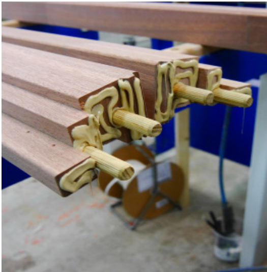
Figuur 2. Lijm streepsgewijs aanbrengen
