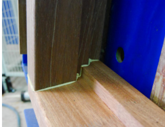
Figuur 3. De lijm wordt naar buiten geperst.
